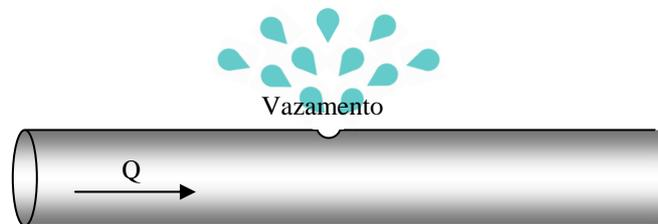
FIGURA 13: Tubulação com Vazamento
