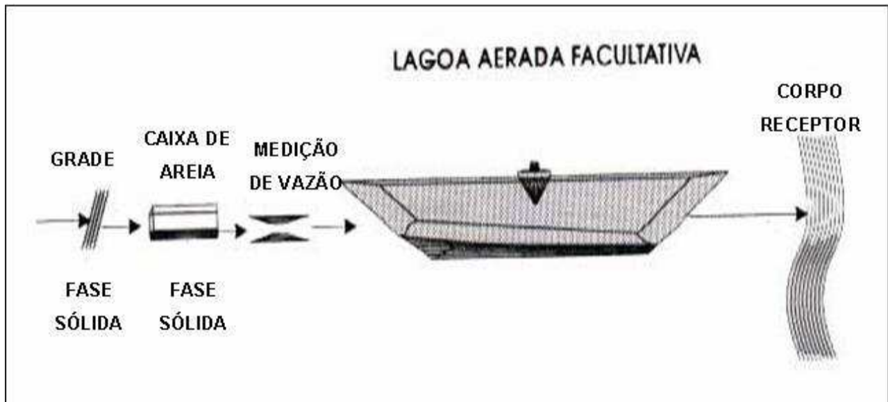
c) Lagoa aerada facultativa
