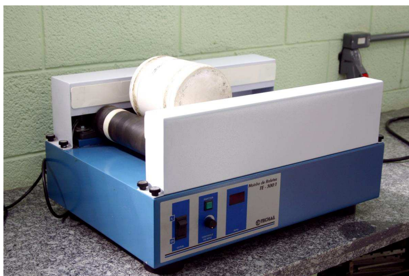
Figura 1. Moinho de bolas utilizado na desaglomeração do resíduo de gesso.
