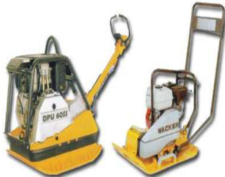
**Figura 7. Compactadores de placas vibratórias**
