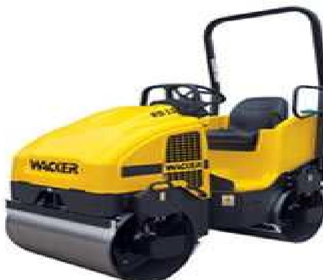
**Figura 14. Compactador com placas reversíveis e rolos vibratórios lisos**
