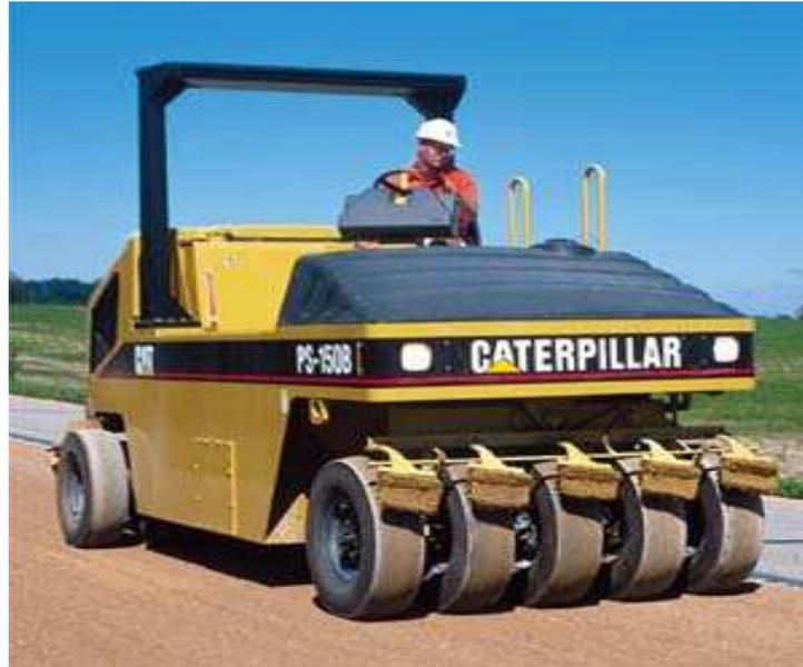
**Figura 11. Compactador de rolo pneumático**
