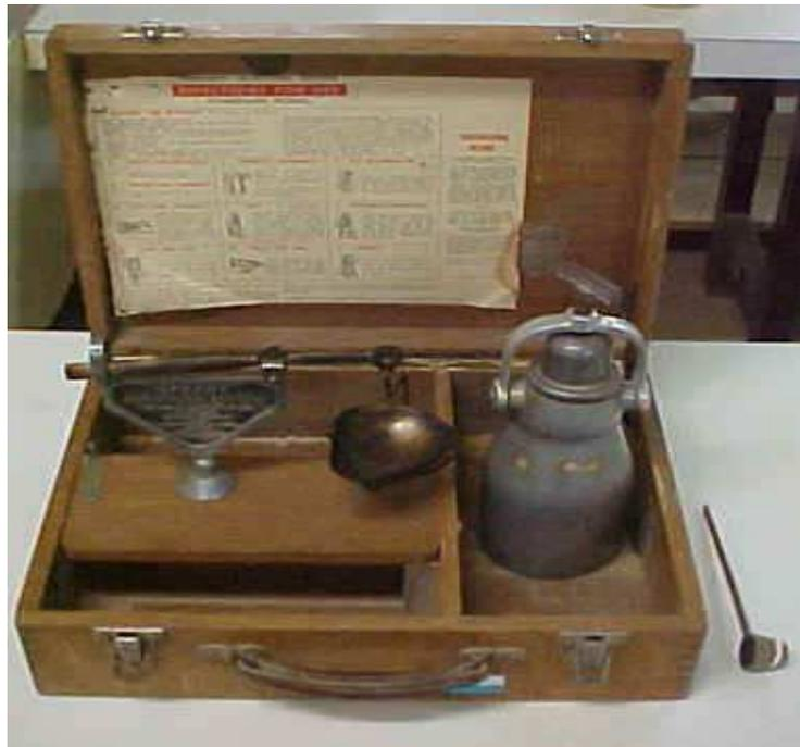
**Figura 18. Equipamento Speed**
