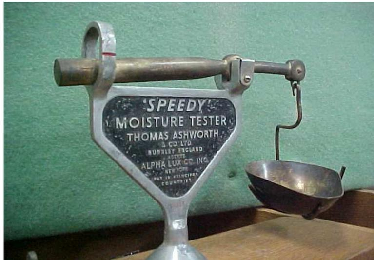
**Figura 20. Balança do Equipamento Speed**
