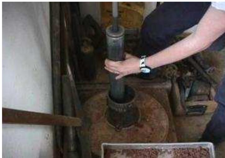
**Figura 16. Equipamento do Ensaio de Proctor**
