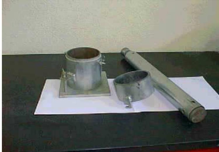
**Figura 15. Ensaio de Proctor**
