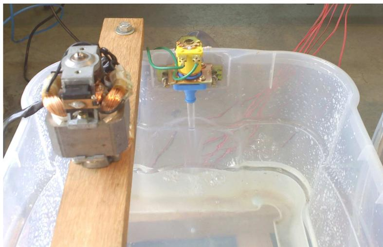
**Figura 5.5 - A válvula solenóide em funcionamento para o reabastecimento do reservatório.**
