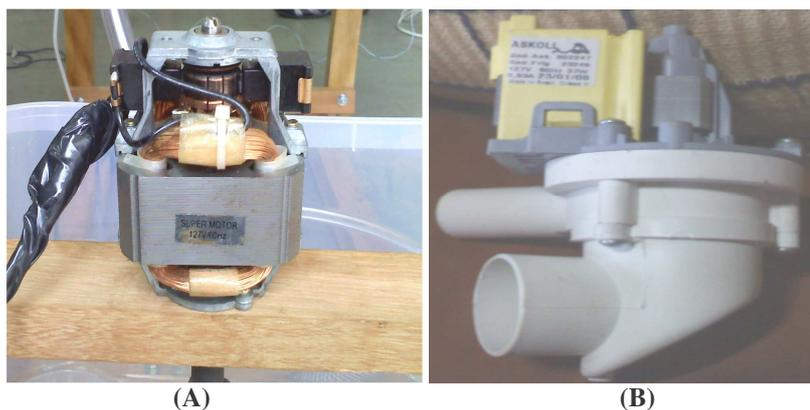
Figura 4.6 – (A) é o motor elétrico Solar usado para a agitação da solução, (B) moto-bomba usada para a circulação da solução nutritiva.
