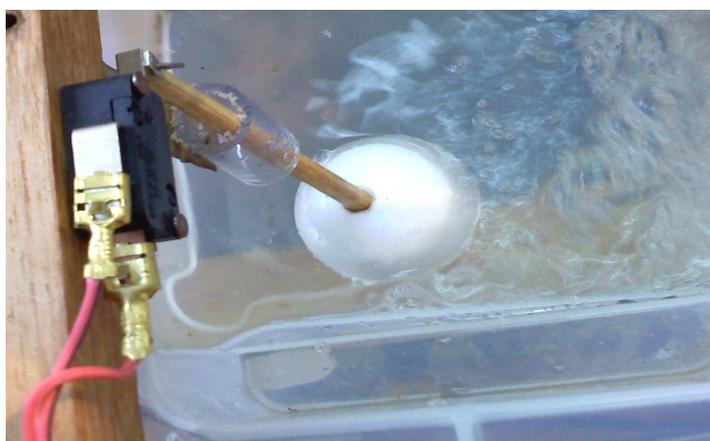
Figura 4.3 - Chave fim de curso com alavanca para o controle dos níveis do reservatório.
