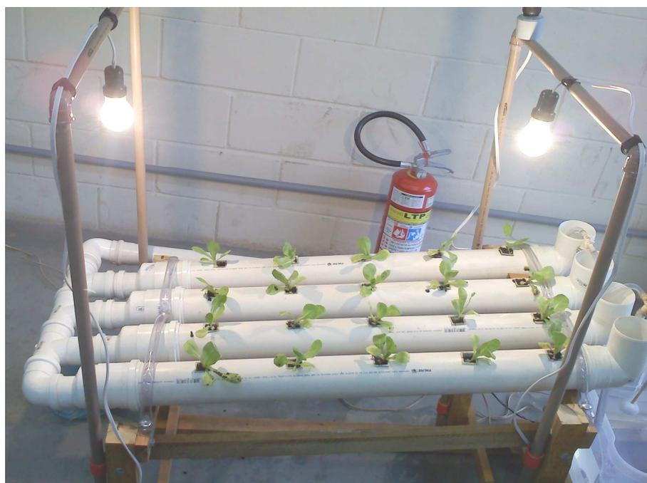
Figura 5.3 – Protótipo do sistema hidropônico tipo NFT, com a iluminação artificial ligada.
