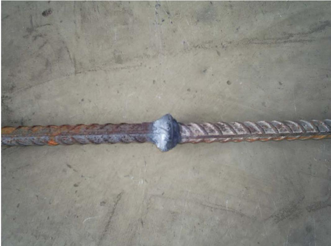
Figura 2.6.1 – Barra de aço soldada.
