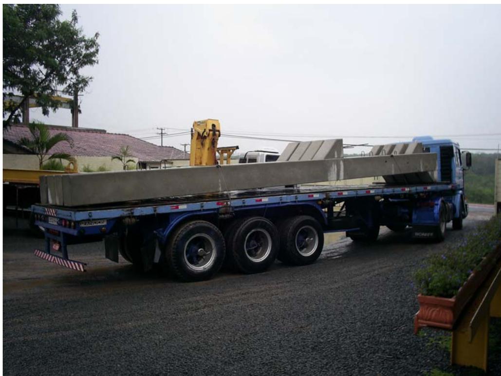
Figura 3.2 – Carreta transportando coluna com 12,50m de comprimento.
