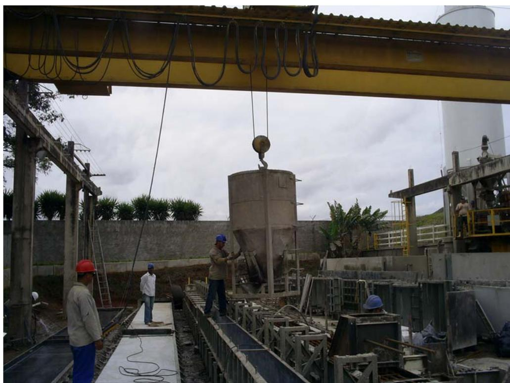
Figura 2.1.5 – Balde de concreto sendo transportado até a fôrma.
