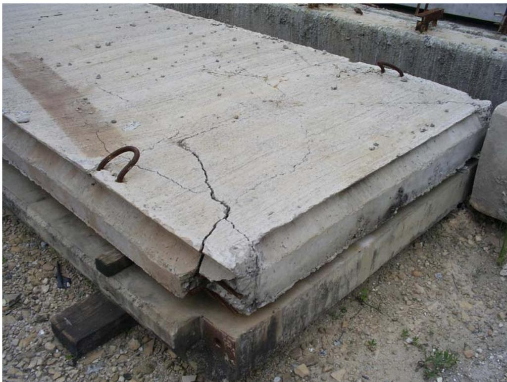
Figura 3.2.1 – Peça danificada devido a patologias no transporte.
