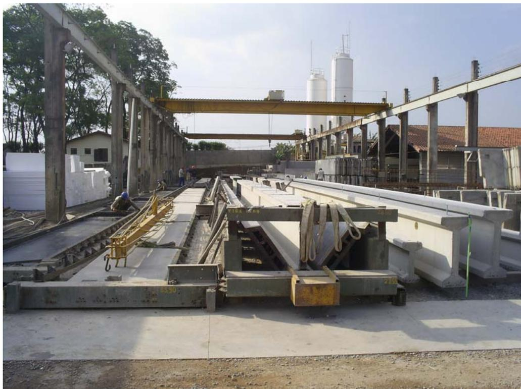
Figura 2.2.2 – Pista de concretagem com 150m de extensão.
