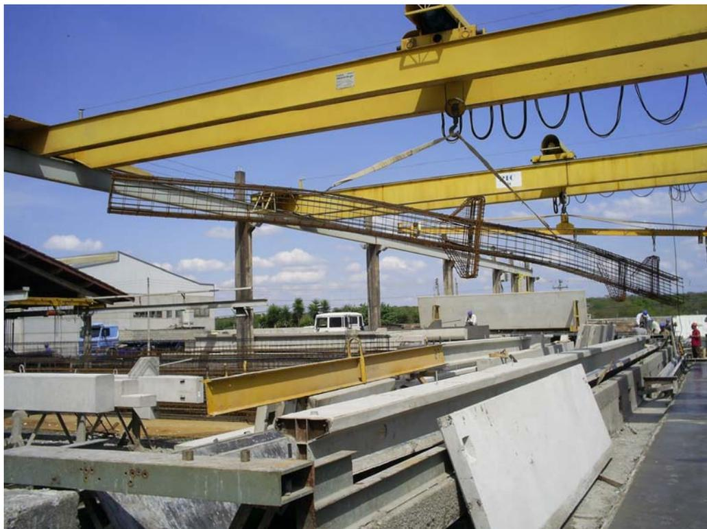
Figura 2.1.4 – Armadura sendo transportada até a fôrma.
