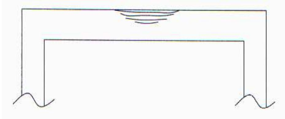
**Figura 5.5 – Configuração da fissuração por esmagamento do concreto**
