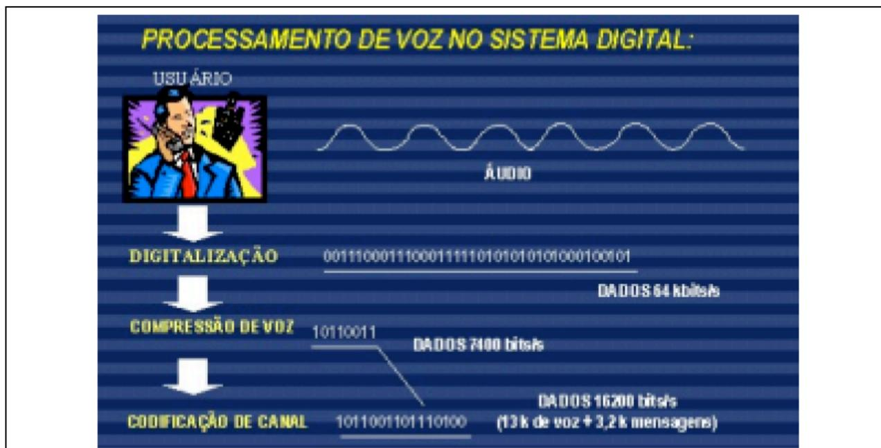
Figura 9. Processamento e voz no TDMA.
