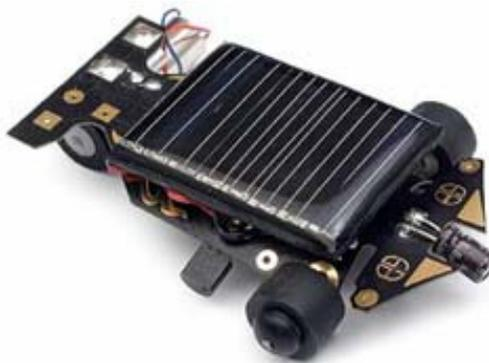
**Figura 01 - Robô Analógico com tecnologia BEAM** (Fonte - Techbotics)
