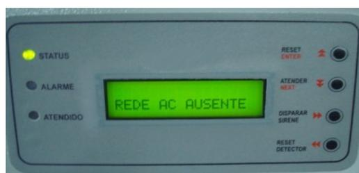
**Figura 28 – Painel indicando falta da corrente Vca**
