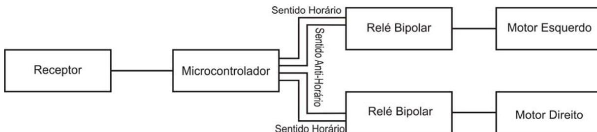
**Figura 22 – Diagrama de bloco da placa receptora**
