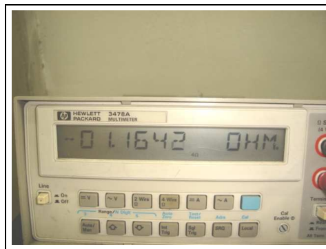
Figura 9. Resistência ôhmica a frio (20 °C)
