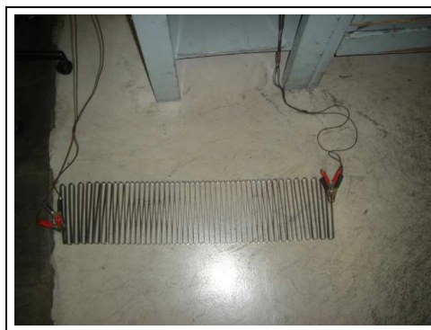
Figura 10. Medindo a resistência ôhmica
