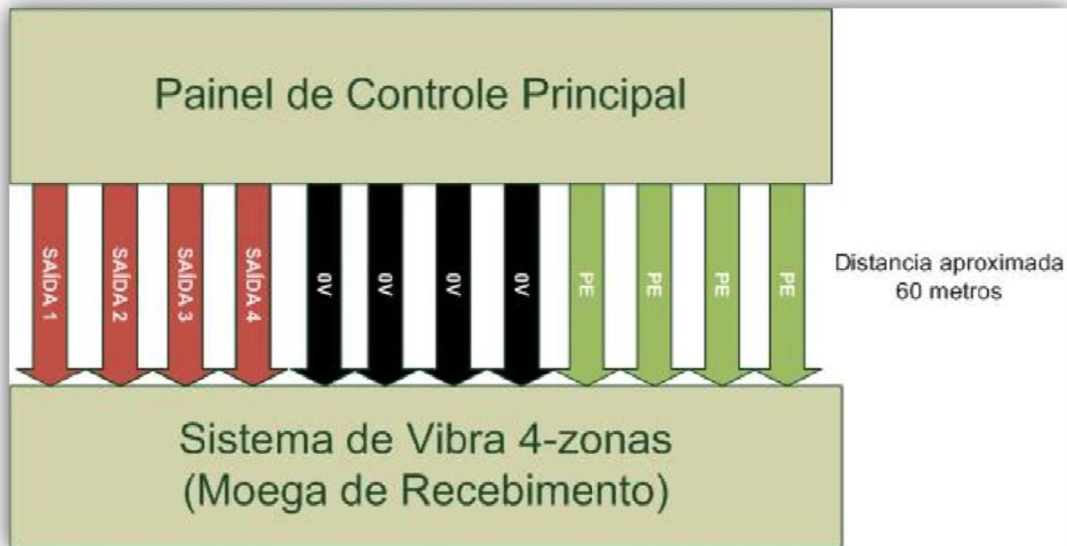
Figura 13. **Diagrama de acionamento utilizado atualmente.**
