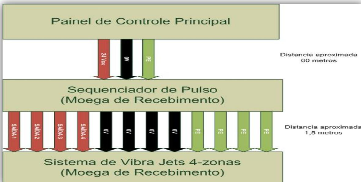
Analisando a nova arquitetura proposta pelo projeto, a utilização de cabeamento passa a ser de 720 metros para 192 metros, proporcionando a utilização de apenas três fios ao instrumento e no intuito de economizar quatro saídas do CLP principal buscando a redução de um módulo de saída digital dependendo do caso e facilitando na manutenção do equipamento por meio de eletrodutos com diâmetro menores viabilizando na otimização do sistema.
