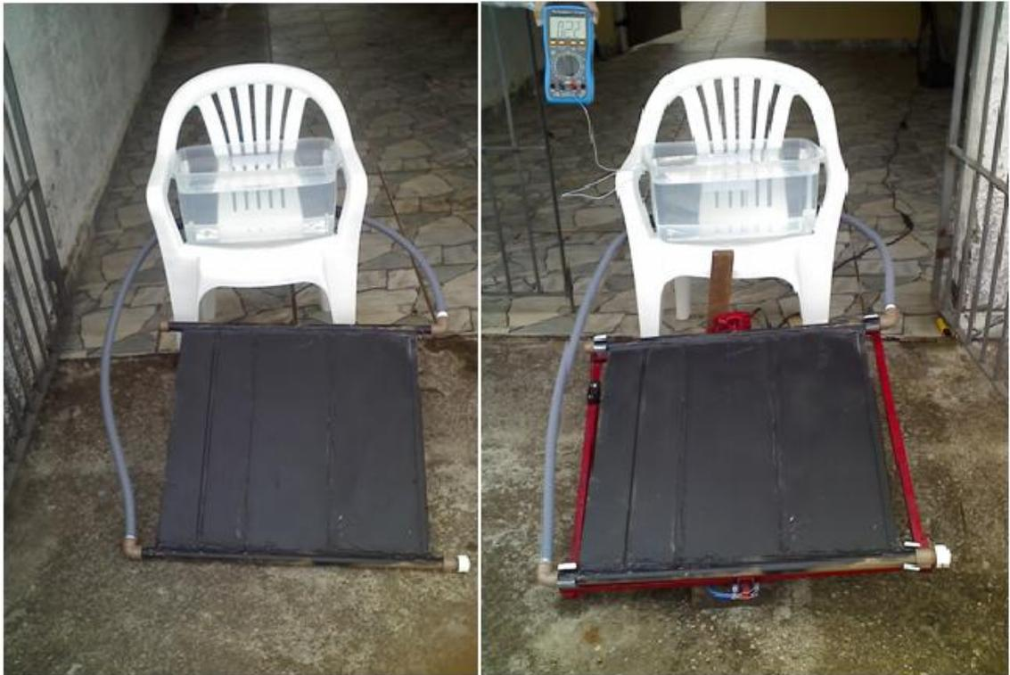
Ilustração 18: Placas Solares em teste prático de comparação.
