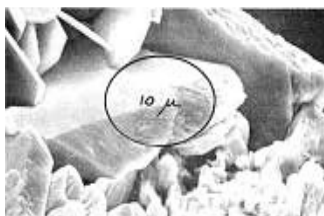
Figura 13 - Bateria de NiCd com formação cristalina.
