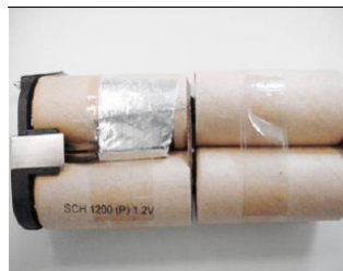
Figura 20 - Detalhe do pacote de baterias
