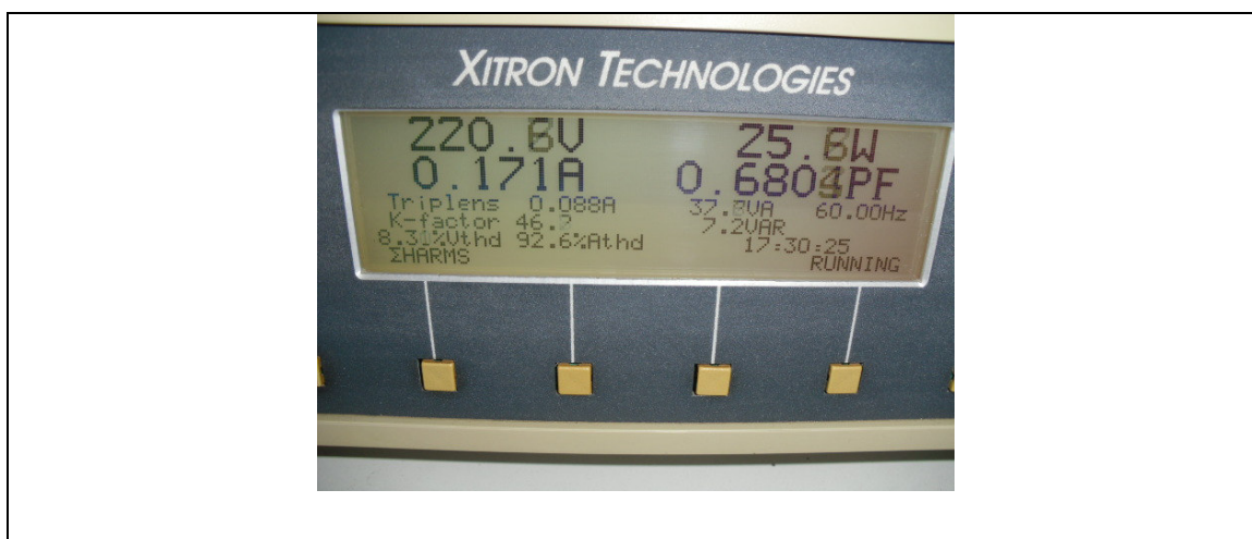
Figura 22. Medições realizada com a amostra de 25W – 220V
