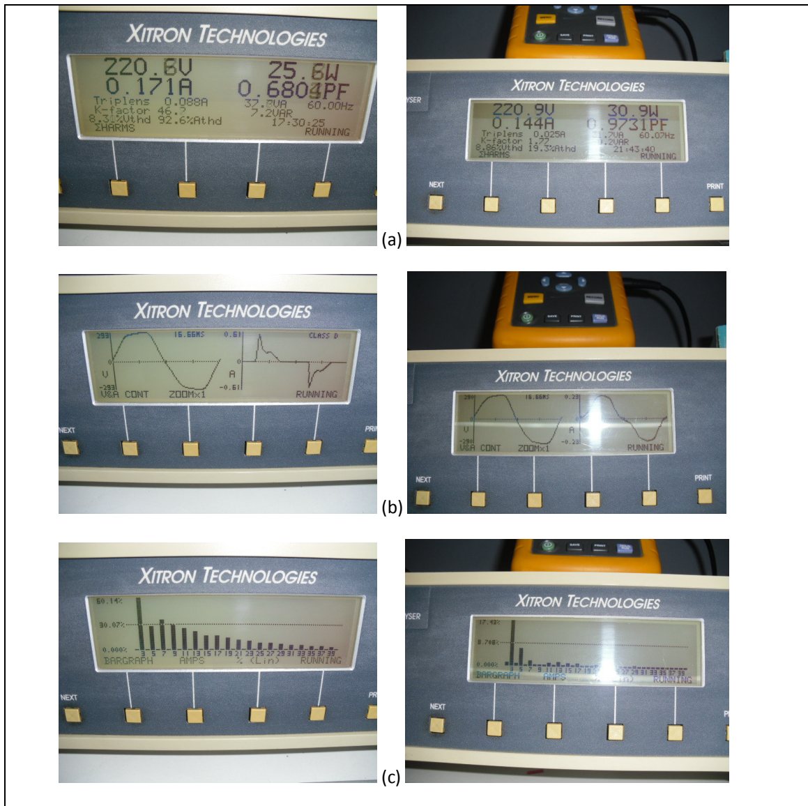
Figura 31. (a) Características elétricas gerais, (b) Formas de onda – Tensão e Corrente, (c) Espectro harmônico de corrente
