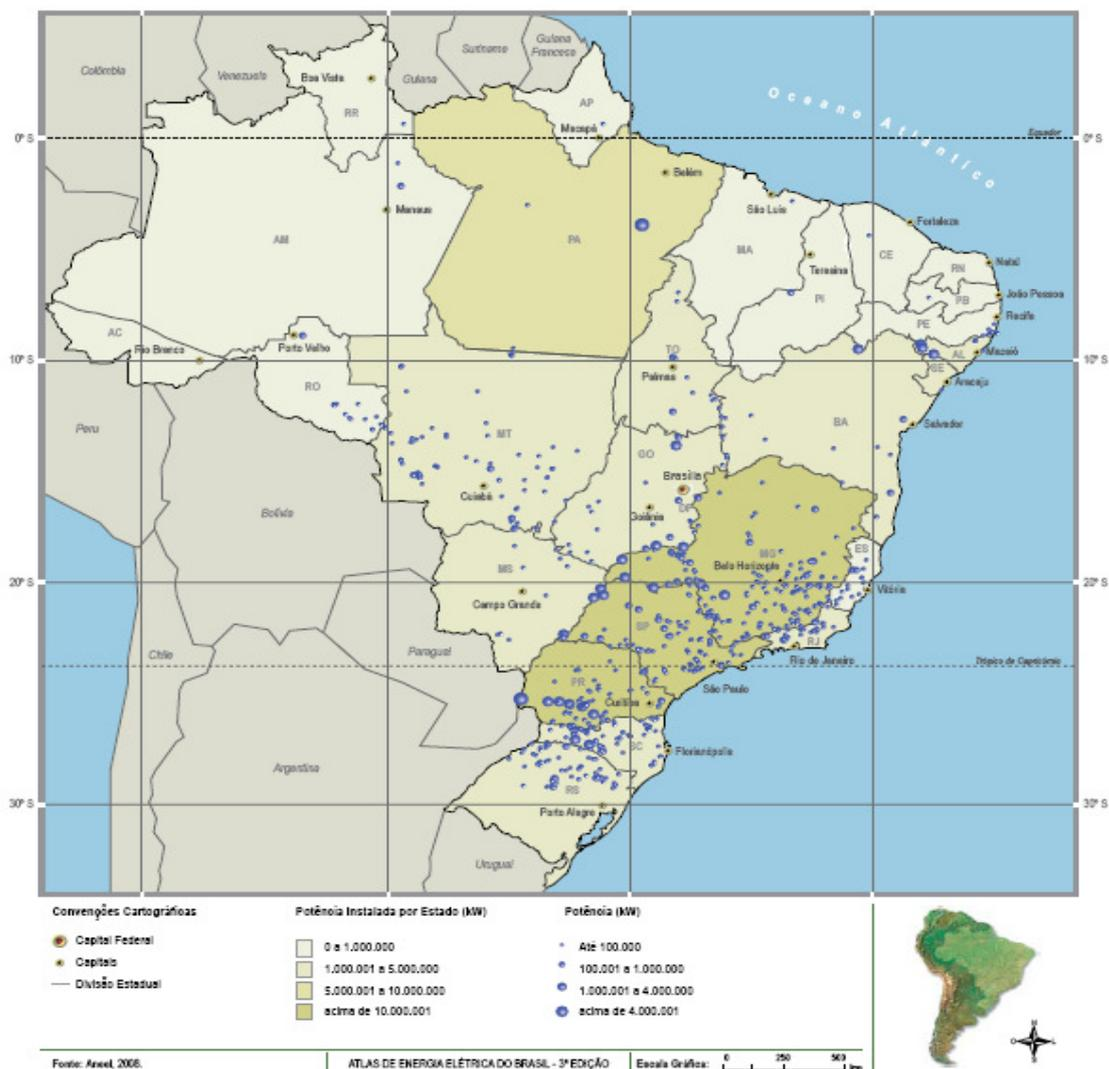
Figura 2 – Potencial Hidrelétrico total instalado no Brasil: Fonte Atlas da Energia Elétrica no Brasil, 3º Edição, ANEEL, 2008.
