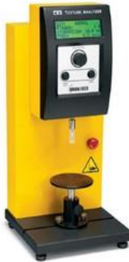
Ilustração 2. Analisador de textura [8].
