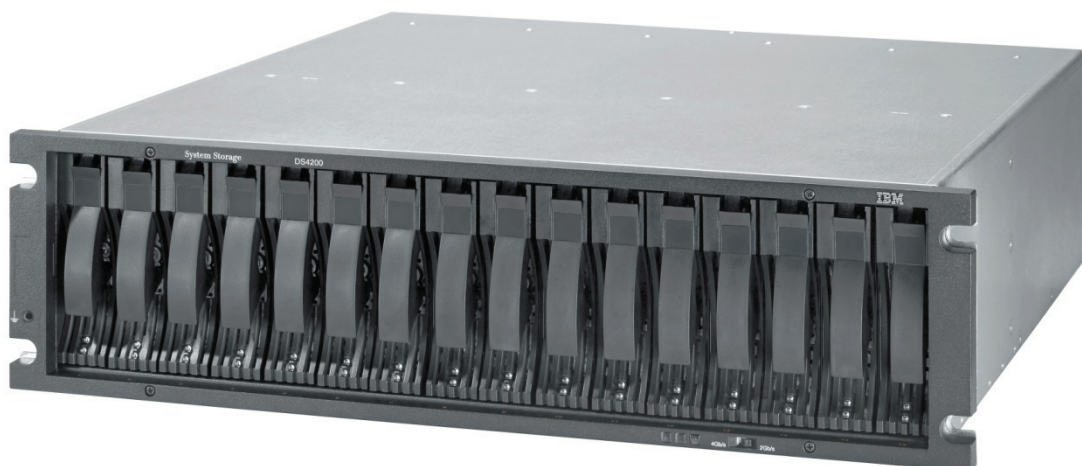
Figura 6 – Exemplo de storage . Neste caso um IBM Storage System DS4200 Express , com capacidade para 16 discos rígidos. Através de placas de expansão é possível conectar mais seis outros DS4200, totalizando 112 discos e até 56TB de espaço total, utilizando discos SAS.
