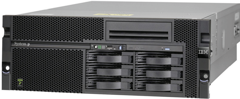
Figura 4 – IBM System P550. Servidor típico para instalação em rack.
