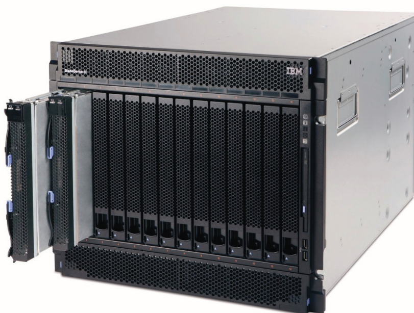
Figura 3 – IBM Blade Serie H. Neste caso um chassi e duas lâminas (ou blades ) semi-instaladas no chassi, os demais são painéis de fechamento para futuras lâminas.
