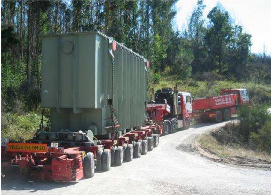
Figura 02. Serviço Transporte de um transformador de 150 toneladas
