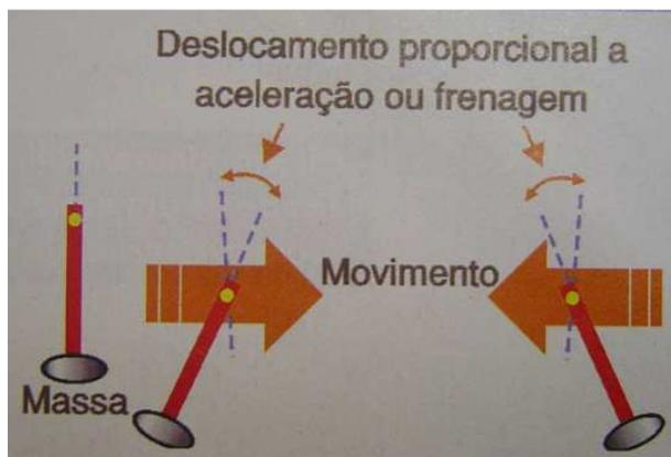
Figura 13. Princípio de Funcionamento de um acelerômetro através de uma massa
