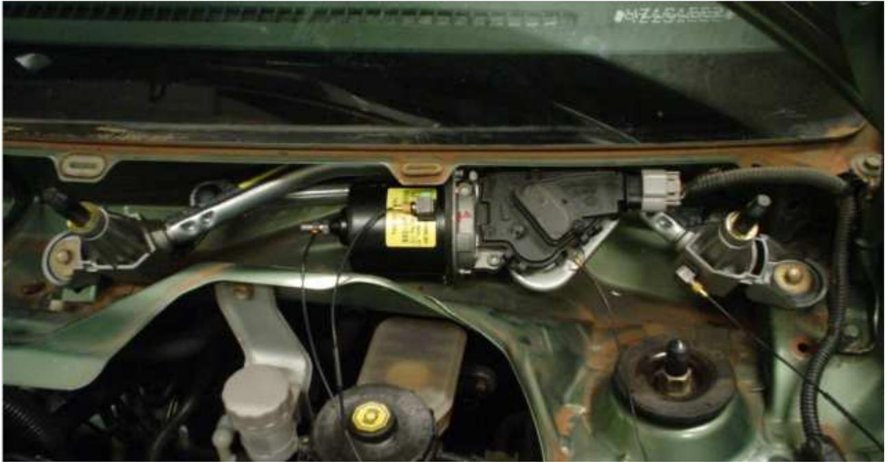
Figura 23. Mecanismo limpador montado no veículo com os acelerômetros acoplados.
