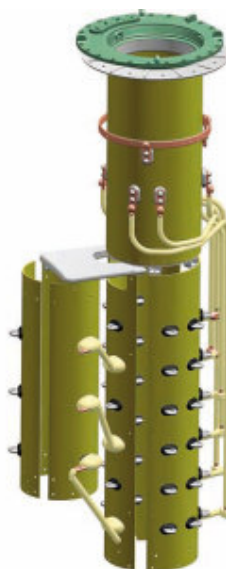
Figura 21- Comutador em carga
