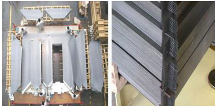
Figura 13 - Empilhamento de chapas em Step Lap (SIEMENS,2006).
