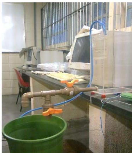
**Figura 3.1.1 - Sistema para controle de nível.**
