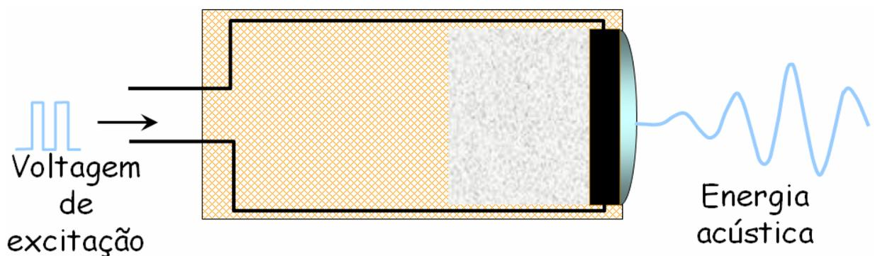
Figura 4: Transdutor: tensão de entrada gerando energia acústica.
