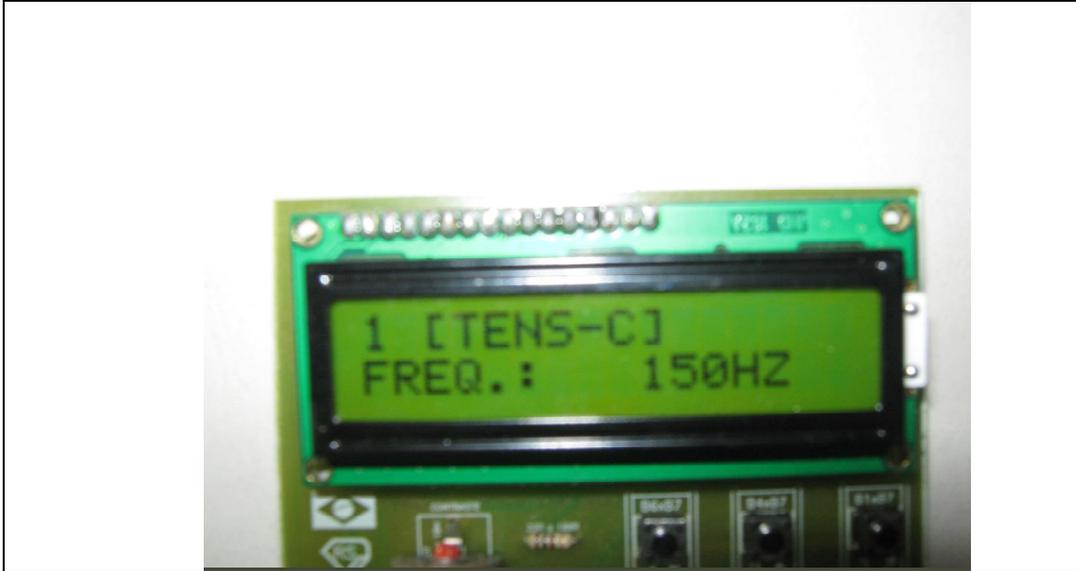
Figura 35. Comunicação com Operador através do LCD
