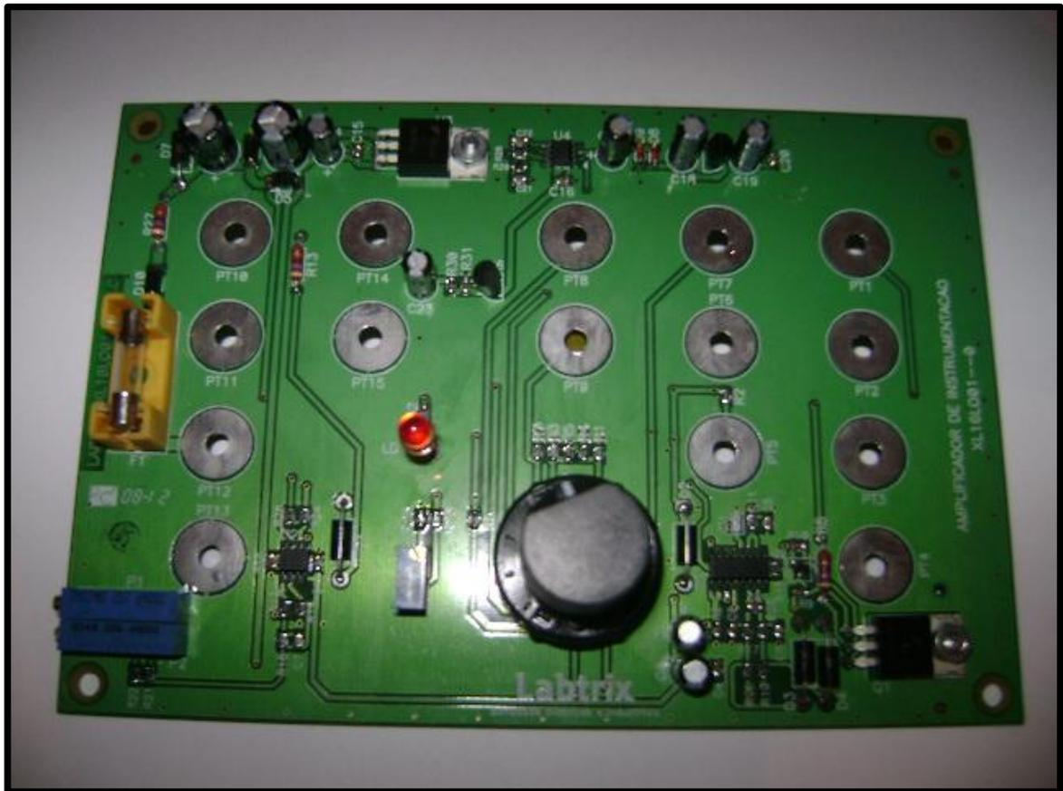
**Figura 3.1:** Foto da placa amplificadora.
