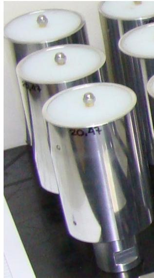
Figura 11 - Transdutores de 20 kHz para geradores de 1000W (Imagem cedida por LS CONTROL AUTOMAÇÃO E SOLDA EM TERMO PLÁSTICO LTDA)
