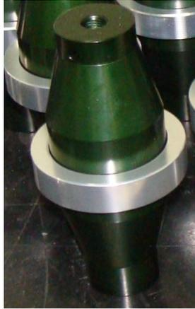
Figura 12 - Transformador acústico de 20 kHz (Imagem cedida por LS CONTROL AUTOMAÇÃO E SOLDA EM TERMO PLÁSTICO LTDA)
