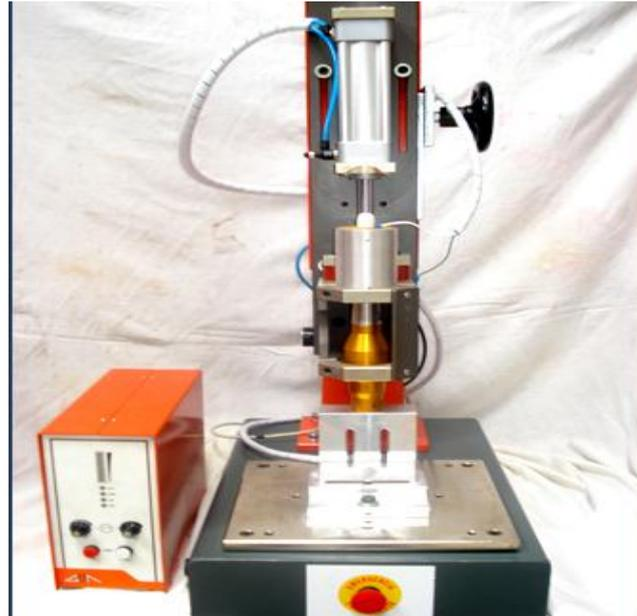
Figura 10 - Máquina bi-manual de prensa pneumática e gerador de ultrassom (GNULTRA-SÔNICA, 2010)
