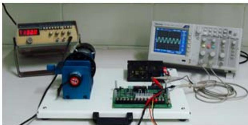
Figura 15: Determinação da indutância
