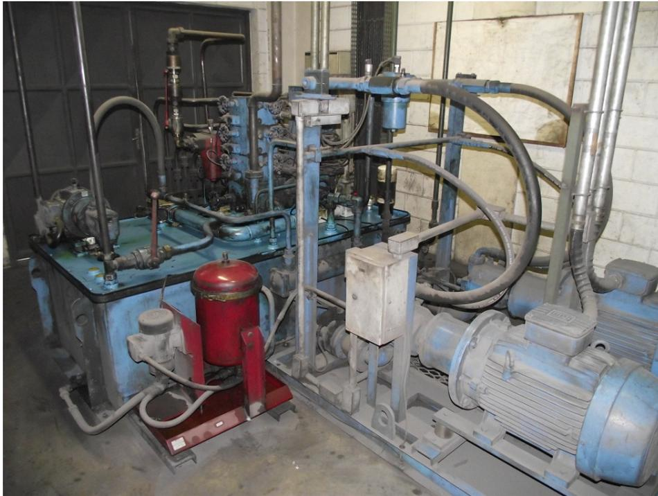
**Figura 3** – Unidade hidráulica
