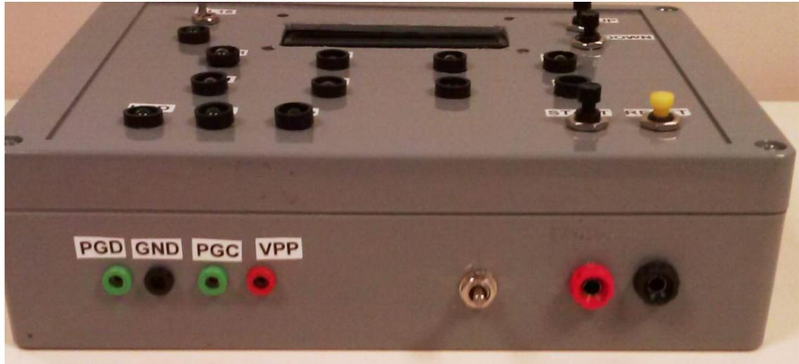
**Figura 27:** Bornes com os sinais necessários para gravação do software.
