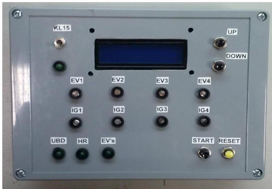
**Figura 14:** Simulador de sinais para motores Otto.
