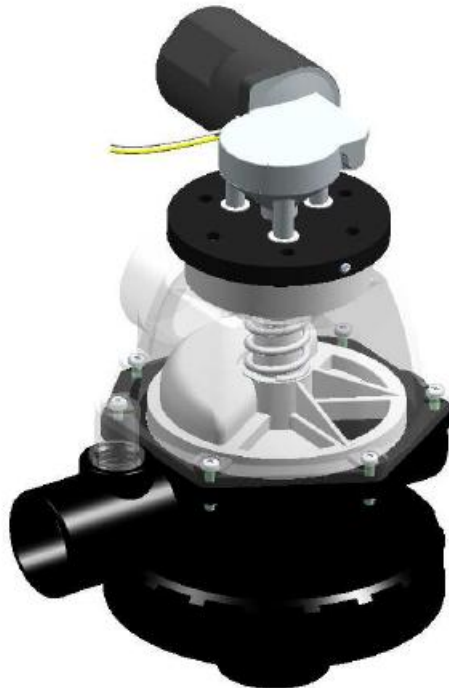
Figura 41 - Desenho da montagem da válvula
