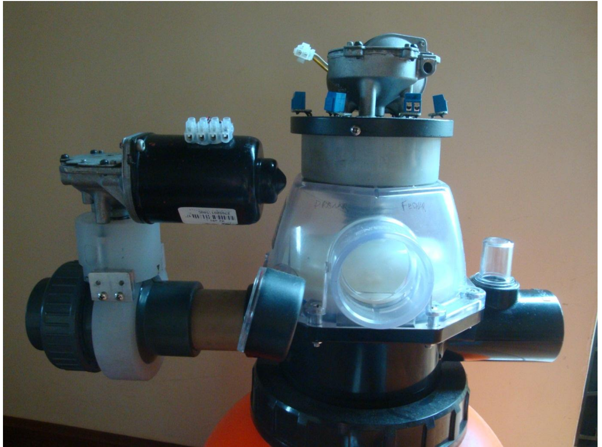
Figura 40 - Registro e válvula automatizados
