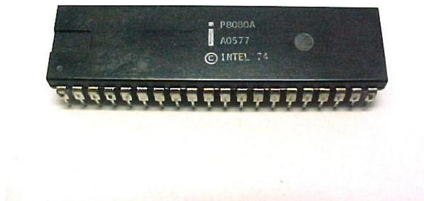
Figura 10: Processador 8080A. (Fonte: <http://infomicroprocessadores.blogspot.com.br/2010/11/o-microprocessador-cpu.html>)
