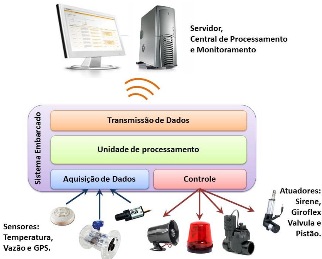
Figura 2.1 – Ilustração de um Equipamento de Telemetria.
