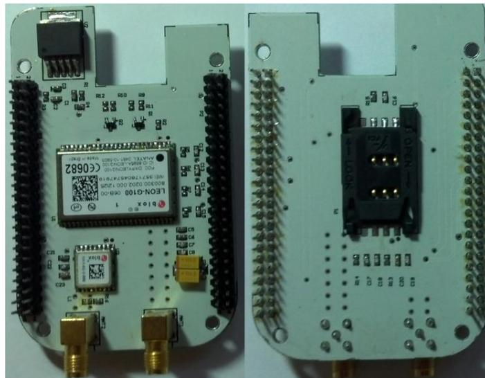
Figura 4.3 – Placa GPS e GPRS montada.
