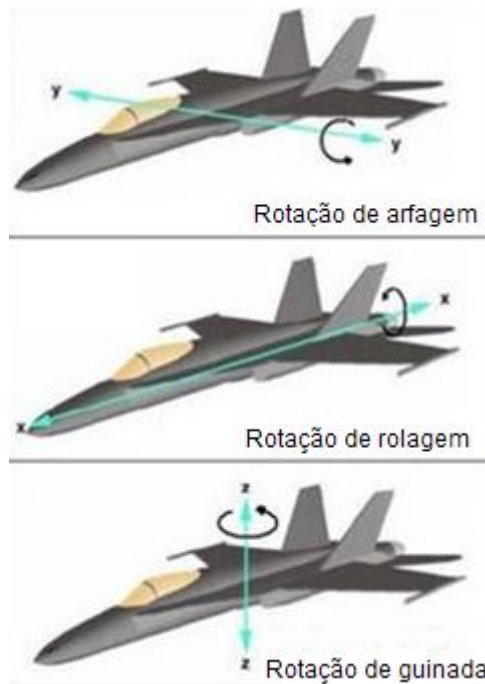
FIGURA 18: Denominação dos eixos de uma aeronave. Fonte: [24]
