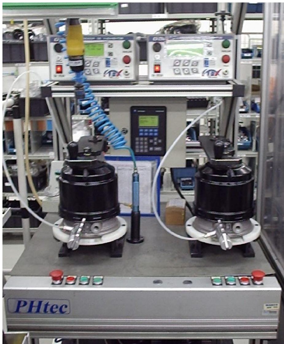
(Foto 7) – Teste de estanqueidade diferencial de pressão – Autor (Próprio)
