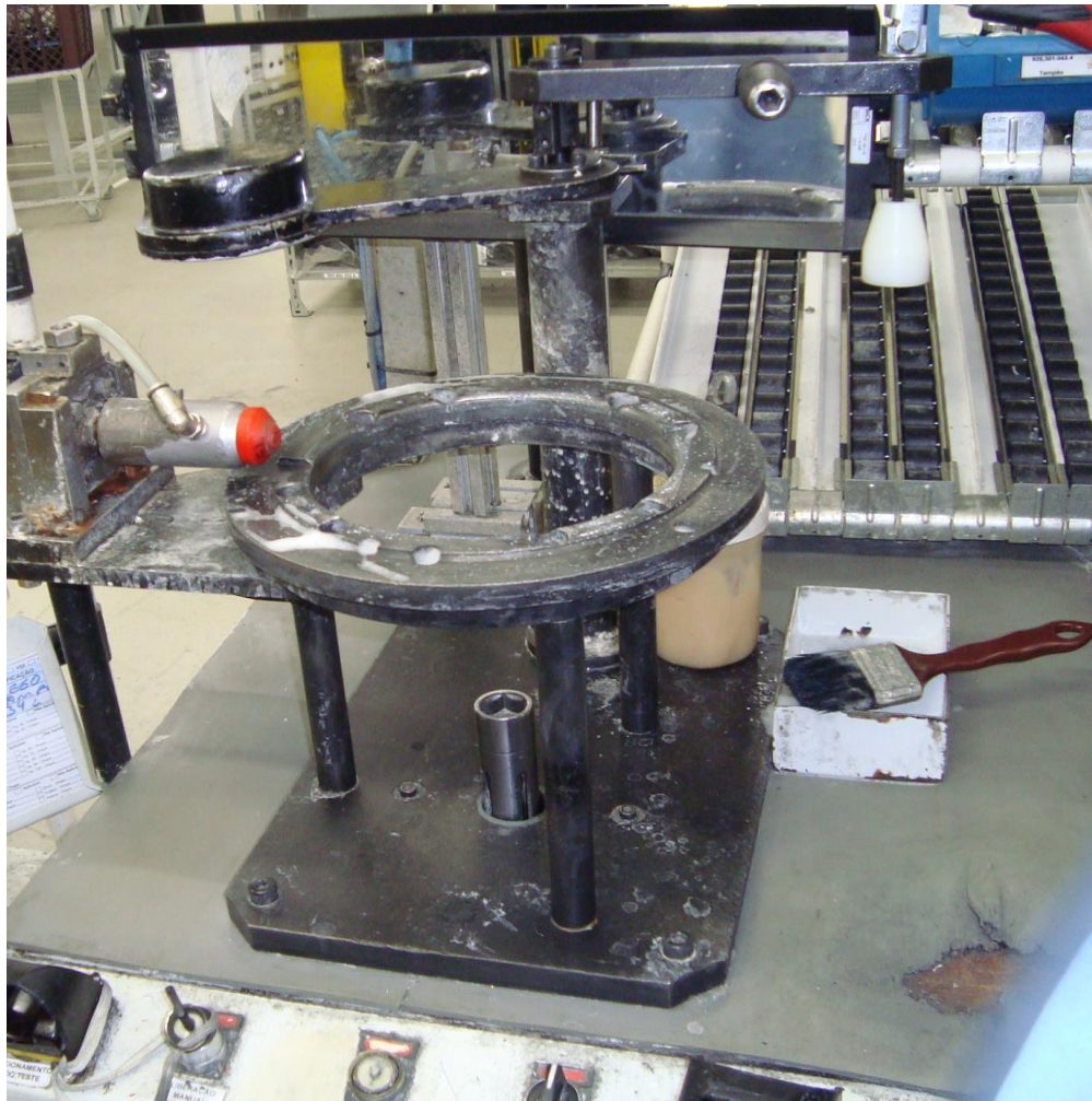
(Foto 6) – Teste de estanqueidade com sabão – Autor (Próprio)
