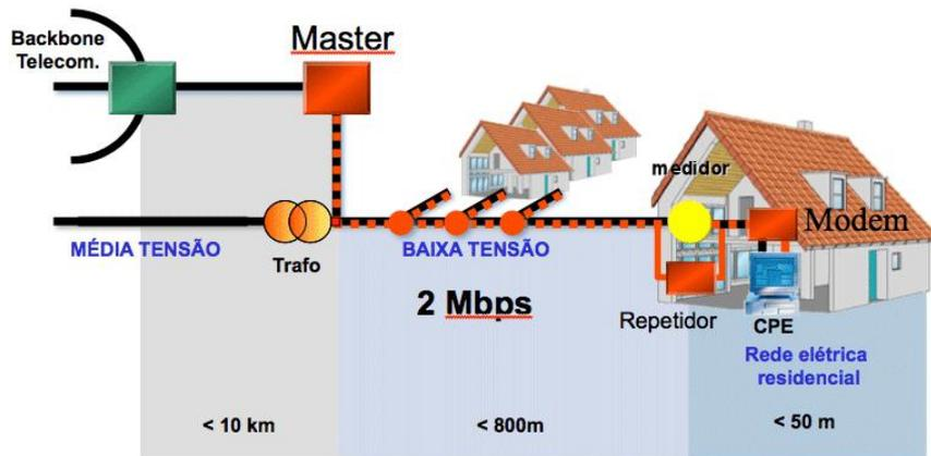
Fig. 7 - PLC configuração típica [10]
