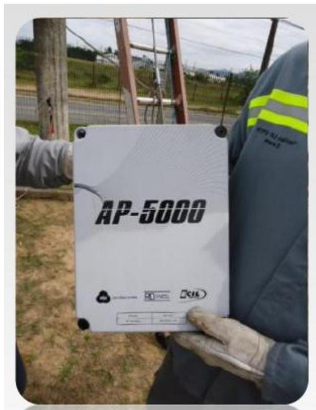
Fig.23 – Coordenador ZigBee AP-5000 [22].
