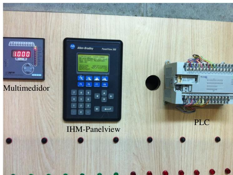
**Figura 18** – Painel com o multimedidor, o IHM e o CLP instalados e energizados
