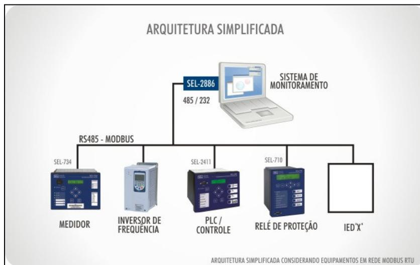
**Figura 8**– Concentrador de Medidores. Fonte – EMG, 2011
