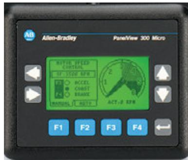
**Figura 26** – Panelview para interfaces eletrônicas. Fonte: Manual do IHM Allen Bradley.
