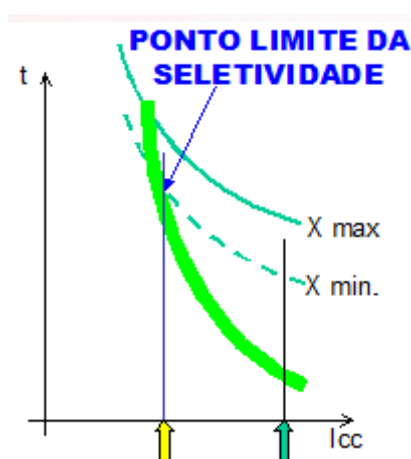
Figura 28: Seletividade entre rele e elo fusíveis
