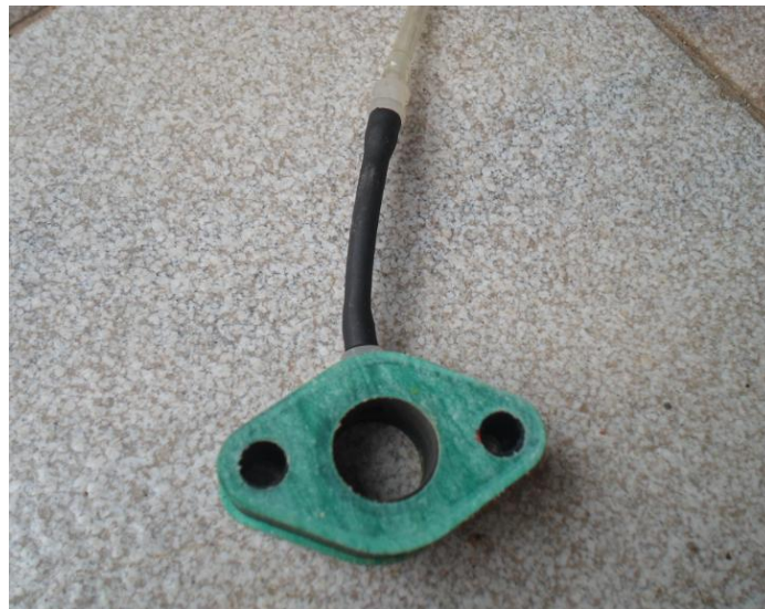
Figura 12- Coletor adaptado para injeção de HHO
