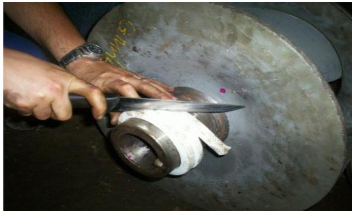
Figura 5. Aplicação da Gaxeta Sealtex Style 1037 – Captação de Água Bruta
