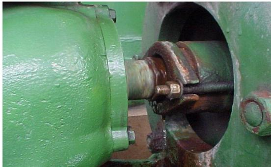
Figura 2. Vista do sistema de engaxetamento e preme-gaxeta
