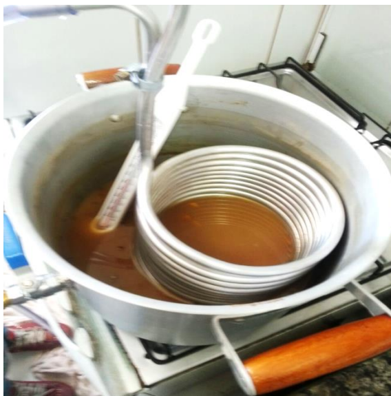
FIGURA 14 – Resfriamento do mosto com auxílio de um trocador de calor tipo serpentina
