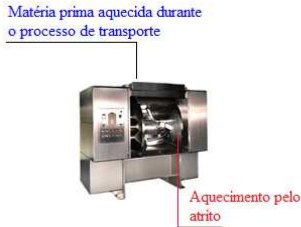
**Figura 2. 27 – Fontes de Temperatura em um Processo de Batimento de Massa para Biscoitos**
