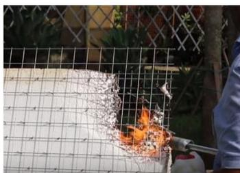
Figura 9: Teste com o isopor Tipo F não propaga o fogo.
