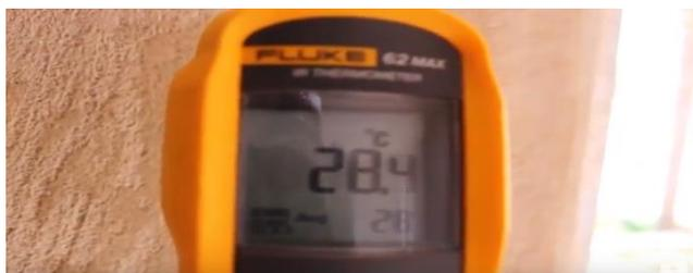
Figura 12: Teste de isolamento térmico, parte interna 28.4 °C.
