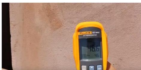
Figura 11: Teste de isolamento térmico, parte externa 46.6 °C.
