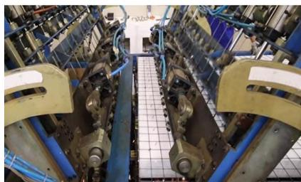
Figura 10: Produção dos painéis e eletro soldagem dos conectores formando um sanduíche.
