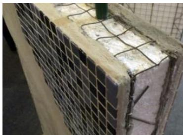
Figura 7: Duas camadas de argamassa e isopor no meio que é o isolante natural e impermeabilizante.
