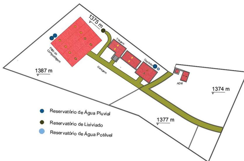
**Figura 6**– Proposta de Layout Usina de Compostagem. Fonte: Autores
