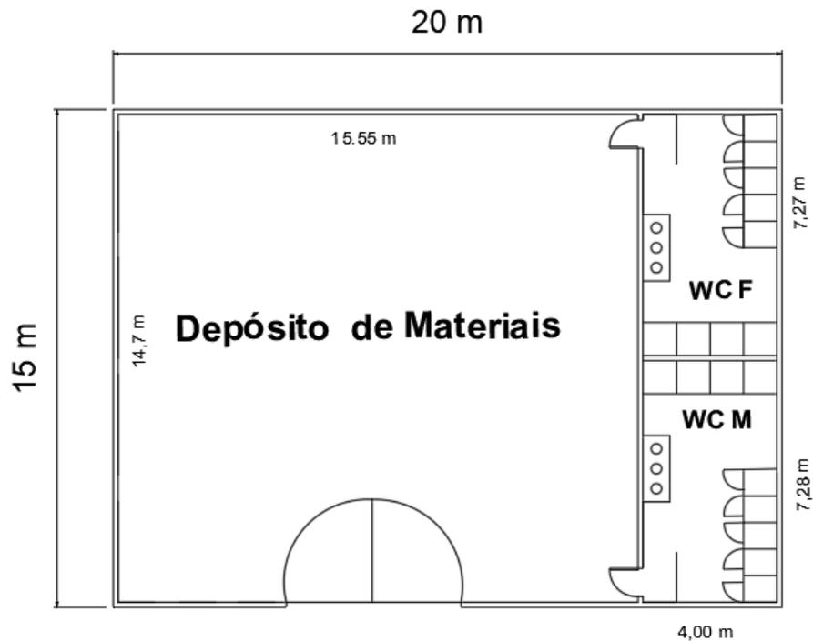
**Figura 4**– Proposta de Layout do Depósito da Usina de Compostagem Fonte: Autores
