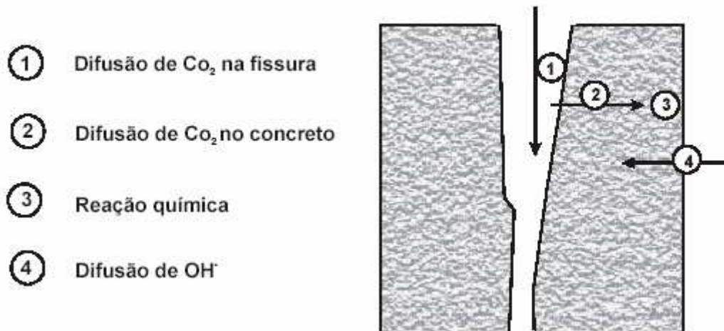
FIGURA 04– Representação esquemática de penetração do CO 2 no concreto (CEB/BI 152, 1984)
