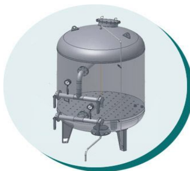
Figura 2.7 Filtro de areia [Estação, 2008].
