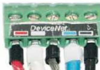
Figura 2.3: Exemplo de conector DeviceNet [4]
