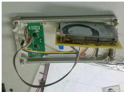
Figura 12. Arduino acoplado ao circuito impresso
