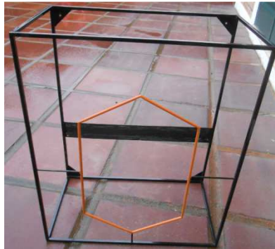
Figura 11. Estrutura Metálica da Estufa
