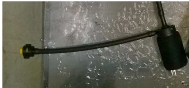
Figura 14. Bomba d'água ligada ao aspersor
