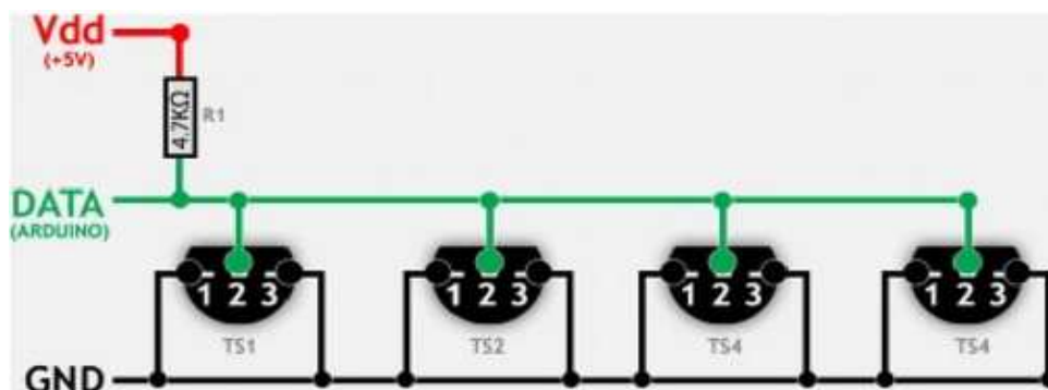
Figura 5. Esquema de vários sensores, ligação parasita.
