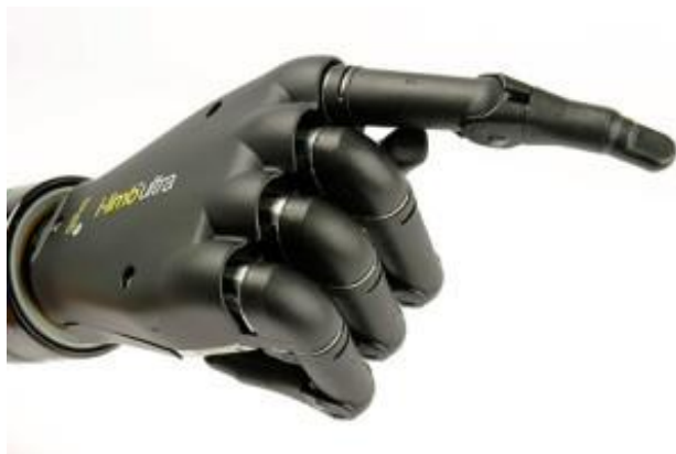
FIGURA 21 - Prótese i-Limb Hand
