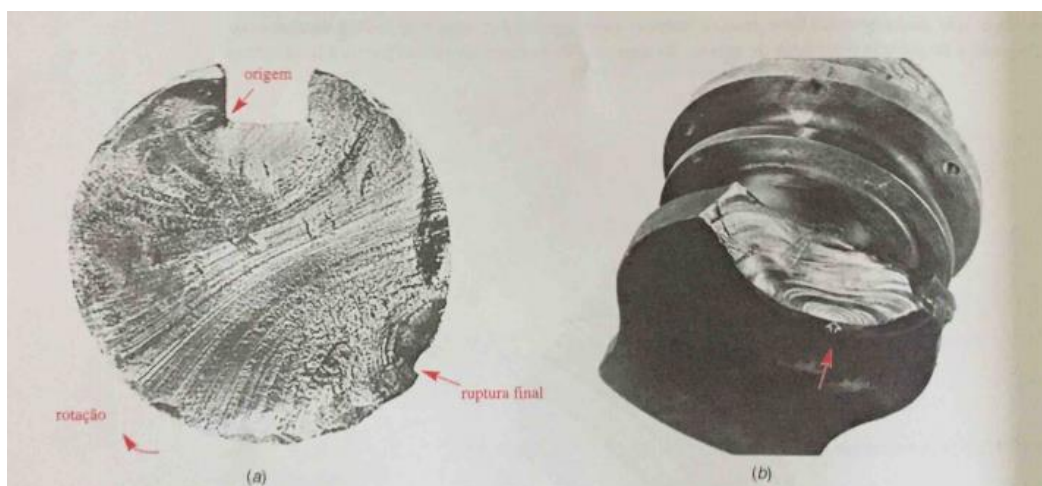
Figura 40: Descrição da Trinca - Fonte: Projetos de Maquinas, Norton (2004)
