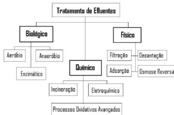
Neste contexto, foram escolhidos três processos para a remoção do cromo hexavalente em efluentes, que são a eletrocoagulação, adsorção e redução química. Tais formas apresentam múltiplas aplicações nas indústrias de galvanoplastia, que fazem o revestimento de peças metálicas com cromo, protegendo da corrosão, e indústrias de curtumes, com o processamento de couro curtido ao cromo.
