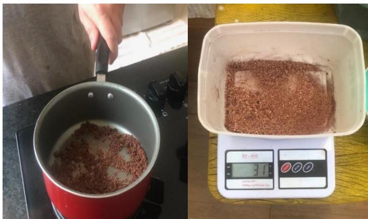
**Figura 4** – Terra sendo “cozida” (à esquerda) e sendo pesada posteriormente (à direita)
