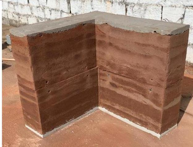
**Figura 12** – Resultado do protótipo após desforma
