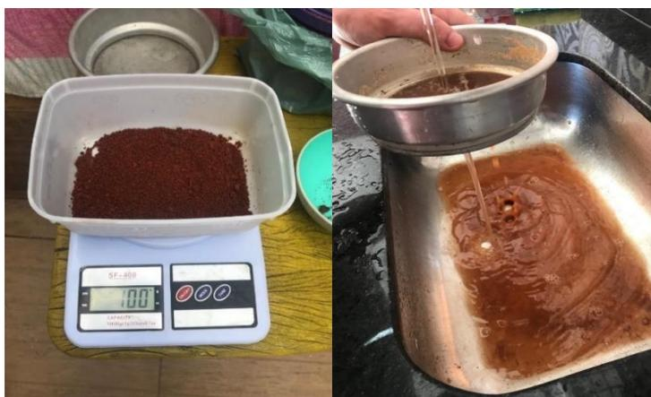
**Figura 3** – Balança com 100g de terra (à esquerda) e processo de peneiramento (à direita)
