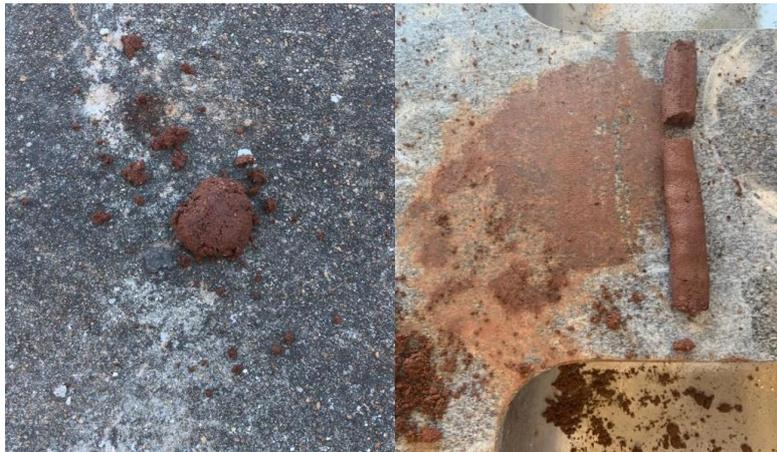
**Figura 5** – Terra com aspecto arenoso (à esquerda) e rolo indicando ser apropriado (à direita) (Fonte: Próprios autores).
